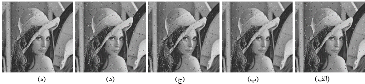
شکل (۳) : تصاویر حاصل از بزرگنمایی تصویر LR با وجود نویز ۲٪، (الف) نزدیکترین همسایه، (ب) دوخطی، (ج) دومکعبی، (د) مبتنی بر موجک، (ه) EDI
