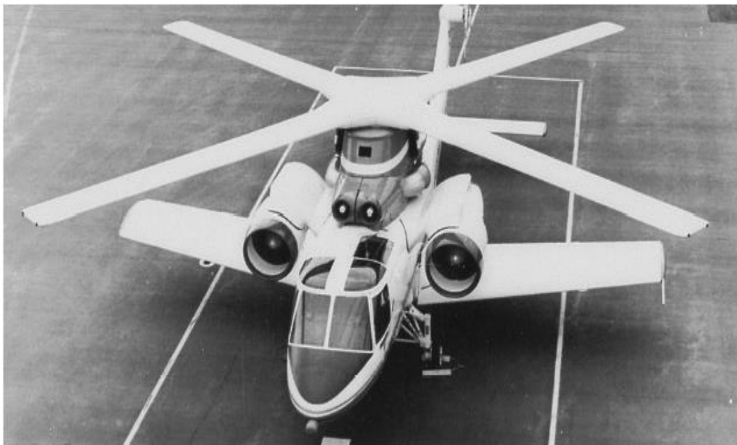
شکل: بال X شکل برای هلیکوپترهای پیشرفته از جنس کامپوزیتهای تقویت شده با الیاف کربن هستند.
