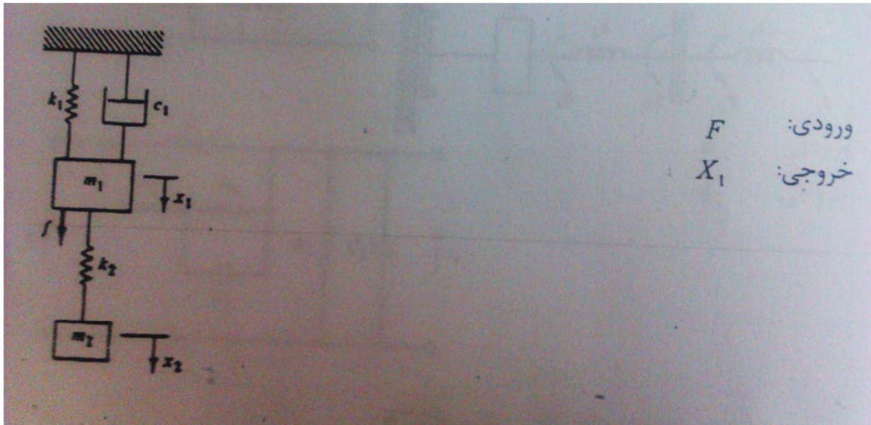
۶- مدل یک چهارم سیستم تعلیق خودرو
