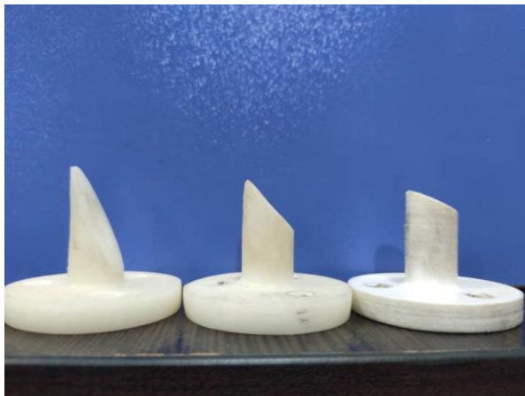
شکل ۱) نشان دهنده ی قسمت واگرای سه عدد نازل اریب است که با پرینتر سه بعدی تولید شده و به ترتیب از راست به چپ دارای زاویه های ۳۰، ۴۵ و ۶۰ هستند.
