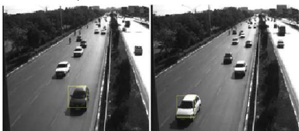
شکل ۱۲. (الف) و (ب) شناسایی اولیه دو خودرو با آستانه ۰/۱۴، (ج) و (د) نتیجه ادغام پنجره‌ها.
