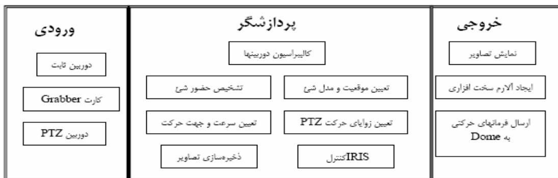
شکل ۱: سیستم طراحی شده به تفکیک بلوک‌های ورودی، پردازشگر و خروجی.
