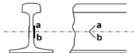
شکل ۶- آرایش کرنش‌سنج‌ها روی جان ریل
