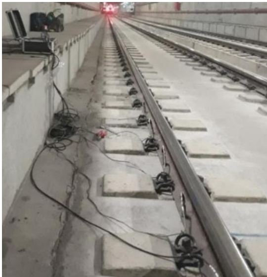
شکل ۴- مجموعه تجهیزات داده‌برداری سیستم جانبی خط
