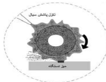
شکل 6: نحوه‌ی پاشش سیال و هدایت آن توسط قطعه دوار مغناطیسی بر روی سطح قطعه کار در روش شارژ پیوسته
