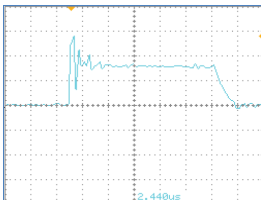
شکل ۱۰: شکل موج جریان دیود D01 (vertical scale 1.5A/div, time scale 1μs/div)
