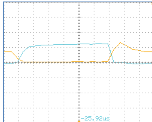
شکل ۸: شکل موج جریان و ولتاژ سوئیچ (vertical scale 25V/div or 4A/div, time scale 1μs/div)
