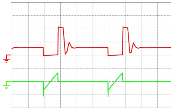
شکل ۱۸- شکل موج جریان و ولتاژ Sa در حالت رفت ( بالا ولتاژ سوئیچ با مقیاس 100V/div، پایین جریان سوئیچ با مقیاس 10A/div، مقیاس زمان 2.5μS/div )
