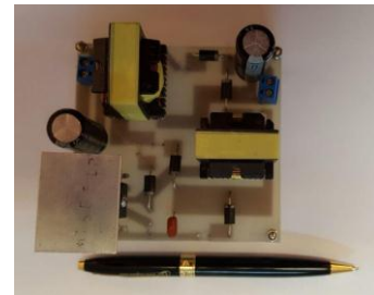
شکل ۱۲- نمونه آزمایشی از مبدل پیشنهادی ساخته شده در آزمایشگاه
