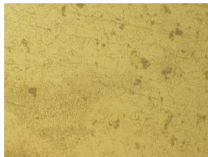
شکل ۳ ریزساختار تیتانیوم خالص تجاری توسط میکروسکوپ
