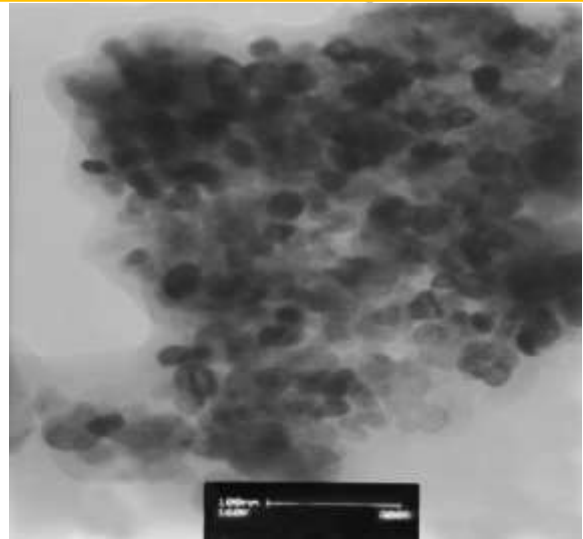
شکل (۴) تصویر TEM نانوکامپوزیت ۹۰CdO-۱۰CdO%
