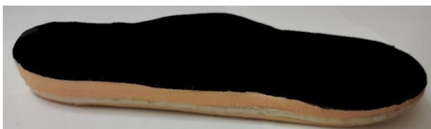
شکل ۶: کفی سه لایه با جنس پلاستوزوت-سیلیکون-اتیلن وینیل استات روش تست عملی:
