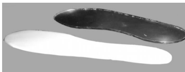
شکل ۵: قالب کفی و سیلیکون قالب‌گیری شده برای لایه‌ی دوم
