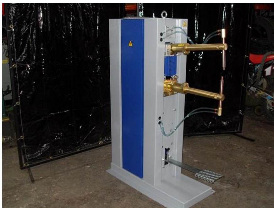
شکل 10. دستگاه جوشکاری مقاومتی نقطه ای
