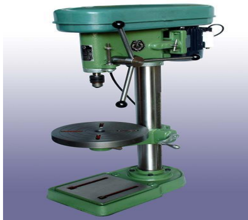
شکل 6. دستگاه سوراخ کاری با مته
