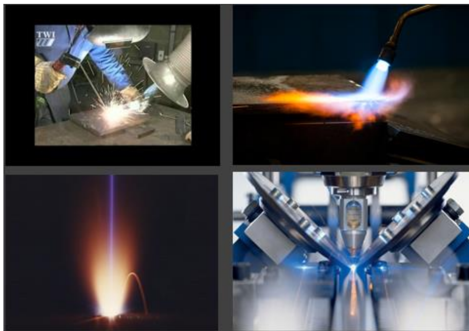
شکل 2. منبع های حرارتی مورد استفاده در جوشکاری نوبی
