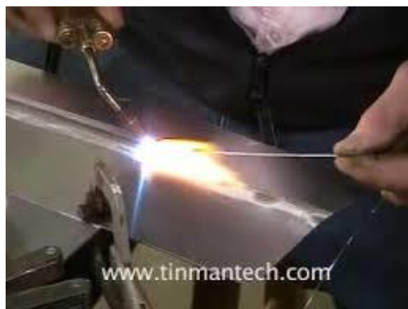
شکل 9. طریقه قرارگیری فلز پرکننده نسبت به مشعل و زاویه ی آن
