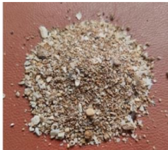
شکل ۱- ماسه کربناته استفاده شده در این پژوهش
