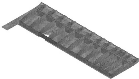
شکل ۲- مدل المان محدود بال هواپیمای سبک مورد بررسی.
