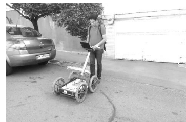
شکل ۱ برداشت داده در منطقه امیرآباد شمالی تهران توسط فاضلیان (نگارنده دوم مقاله) شکل ۲- مقطع زمانی پروفیل شماره ۸ با اعمال فیلتر Dewow و استفاده از بهره Autogain
