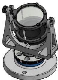
شکل ۴- نمای سه بعدی قطعه اپتیکی چرخان شامل عدسی ها و چرخ دنده های کوپل شده به استپ موتورها که توسط سامانه هوشمند بر بستر اینترنت پایش و کنترل می شود (ساخته شده توسط تیم نویسندگان مقاله).
