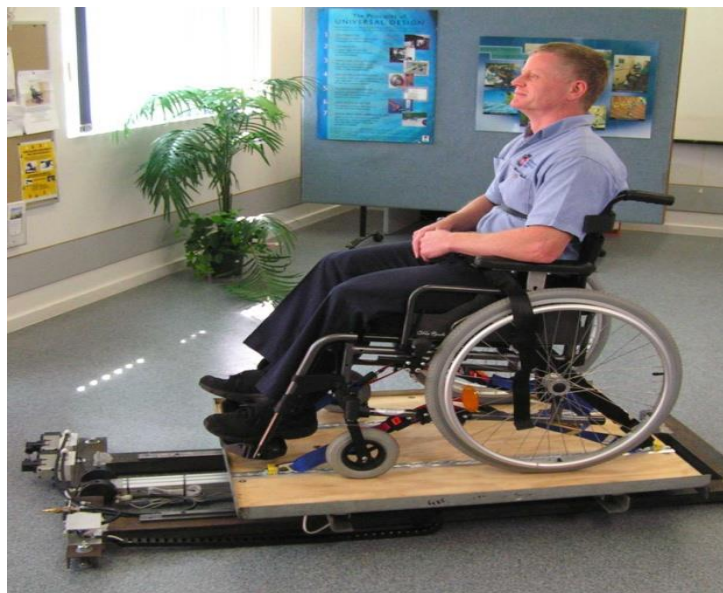
شکل (۱): نمایشی از سکوی بار برای اندازه گیری COFM ویلچر با سرنشین.
