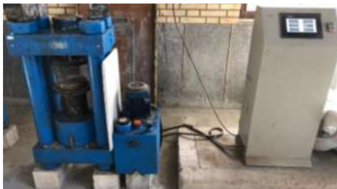
شکل ۴- دستگاه جک آزمایش مقاومت فشاری استفاده شده.
