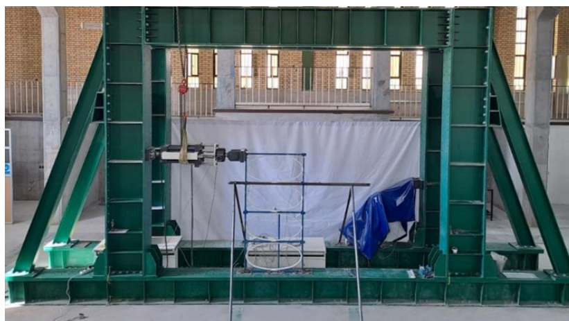
شکل ۲- چیدمان آزمایش و تجهیزات ابزار دقیق در قاب خمشی فولادی چند طبقه مجهز به مهاربند بیضی
