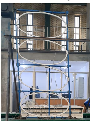
(ه) جابجایی ۸۰ میلی متر، دیررفت ۴ درصد
