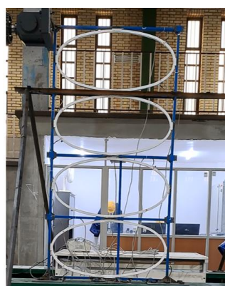
(ب) جابجایی ۲۰ میلی متر، دیررفت ۱ درصد
