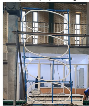
(ز) جابجایی ۱۲۰ میلی متر، دیررفت ۶ درصد
