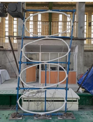
(ح) جابجایی ۱۴۰ میلی متر، دیررفت ۷ درصد
