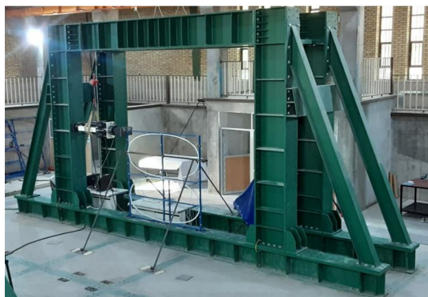
شکل ۲- چیدمان آزمایش و تجهیزات ابزار دقیق در قاب خمشی فولادی چند طبقه مجهز به مهاربند مگابیضی
