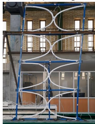
(ح) جابجایی ۱۴۰ میلیمتر، دریفت ۷ درصد
