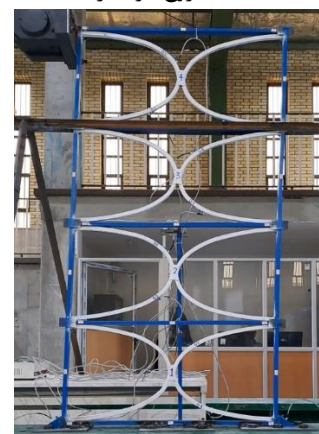
(و) جابجایی ۱۰۰ میلیمتر، دریفت ۵ درصد
