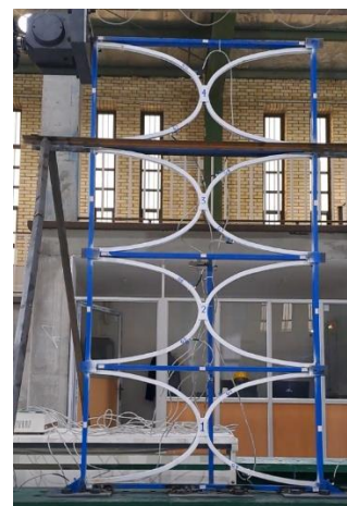
(ج) جابجایی ۴۰ میلیمتر، دریفت ۲ درصد
