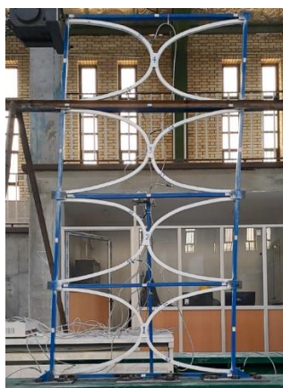
(د) جابجایی ۶۰ میلیمتر، دریفت ۳ درصد
