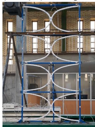
(ز) جابجایی ۱۲۰ میلیمتر، دریفت ۶ درصد
