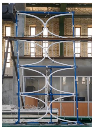
(ه) جابجایی ۸۰ میلیمتر، دریفت ۴ درصد
