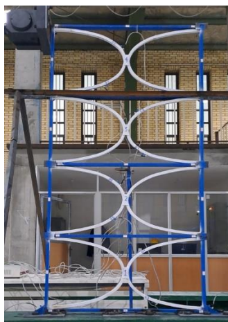
(ب) جابجایی ۲۰ میلیمتر، دریفت ۱ درصد
