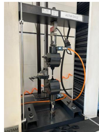
شکل ۳. تست استحکام کششی، ازدیاد طول
