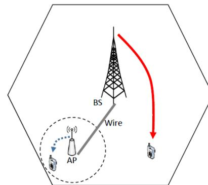
**Fig. 1.** A WiFi Offloading Scenario.
